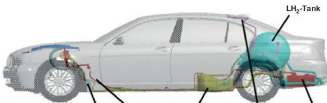
Figura 22 – Disposição do tanque que armazena hidrogênio no carro Hydrogen 7 [11]
